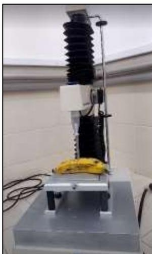
**Figura 16** - Texturômetro perfurando uma banana tratada. **Fonte:** Autor.
