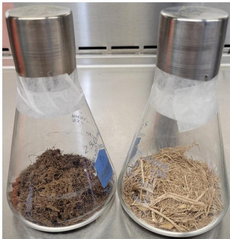
Figura 3-1: Frascos contendo apenas bagaço de cana tratado por explosão a vapor (esquerda) e *in natura* (direita) após autoclavagem.
